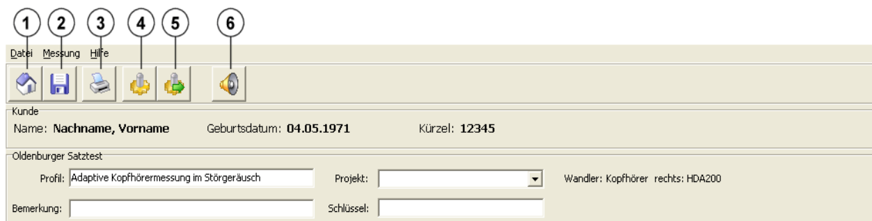
Abbildung 16: Oberer Bereich des Messdialogs. Knopf 6 kann je nach Konfiguration des Systems fehlen.
